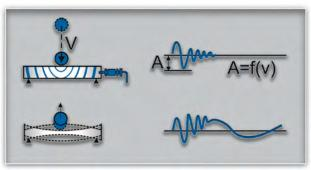
Метод ударных импульсов можно представить на примере падения металлического шарика на металлическое тело. Ударные волны появятся в обоих телах. Амплитуда этой ударной волны равна функции скорости соударения тел.
