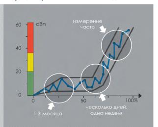
Сила ударного импульса зависит от скорости соударяющихся тел V, если A представляет пиковое значение ударного импульса, тогда возникает соотношение A=f (V), в то время, как скорость соударения V также зависит от размера подшипника, скорости вращения и размера повреждения.
