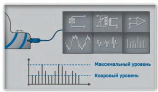
Суммарная интенсивность ударных импульсов возрастает при уменьшении толщины смазочной пленки. Явно выраженные пики ударных импульсов сигнализируют о появлении дефектов в подшипнике.
