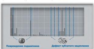
Мониторинг интенсивности вибрации позволяет выявить нарушения в машине, но для определения причин неисправности необходимо использовать метод спектральной вибродиагностики.
